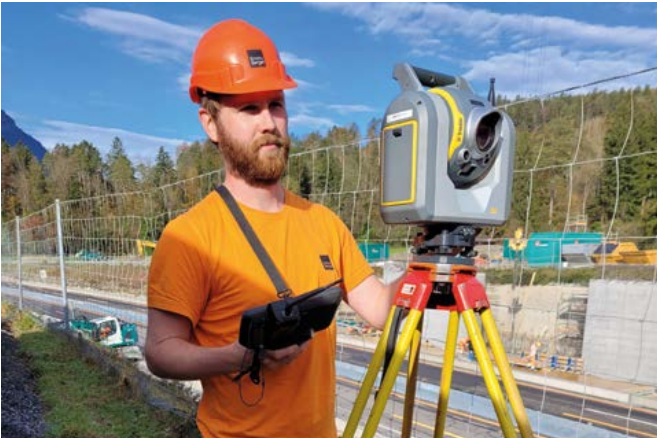
Ein wichtiger Teil der Aufgaben von Dominik Wisler ist die Überwachung der bestehenden und neu erstellten Bauwerke auf allfällige Verschiebungen. Hier im Bereich der Wildtierüberführung Rötlen.
